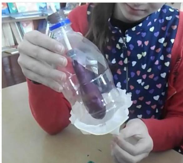
Теперь режем резиновую перчатку так, чтобы вырезать максимально большой круг. Подкладываем вырезанный круг с нижней стороны перерезанной бутылки и обвязываем его резиновым кольцом так, чтобы круг образовал герметично закрепленное
